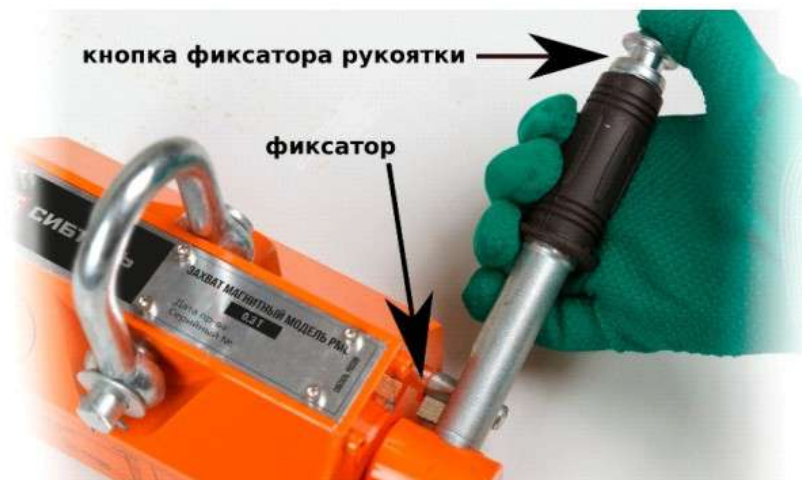
Рисунок 3. Порядок работы с магнитным захватом.
